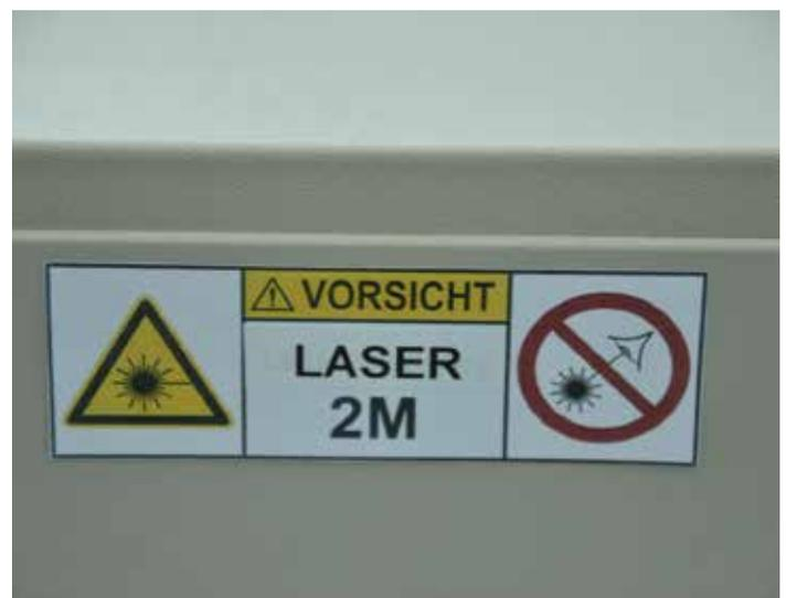
Abb. 35 und 36: Kennzeichnung von Lasern der Laserklassen 2 und 2M, Quelle: BG ETEM
