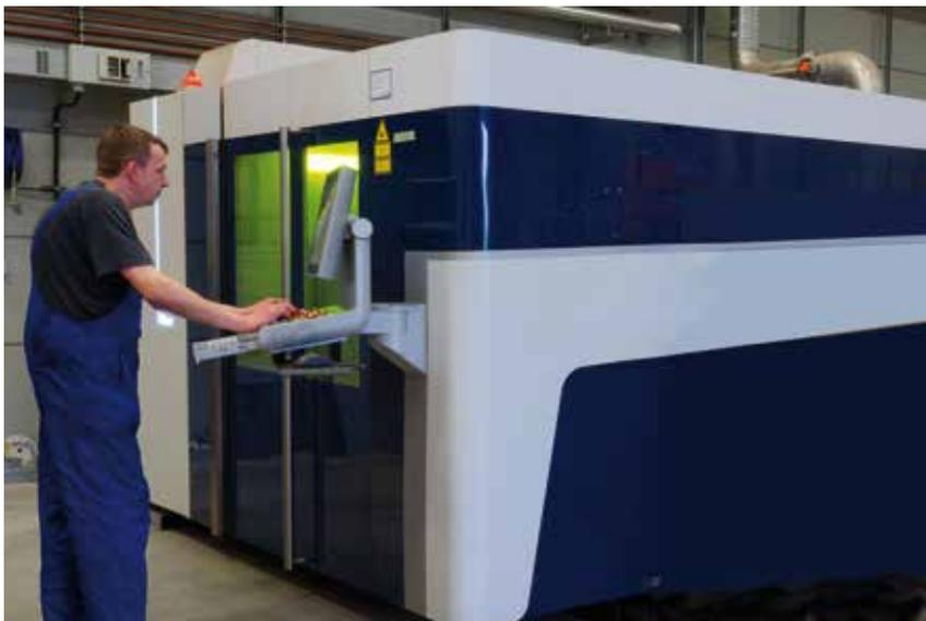
Abb. 43: Eingehauste Laserbearbeitungsmaschine, Quelle: Laserzentrum Nord
