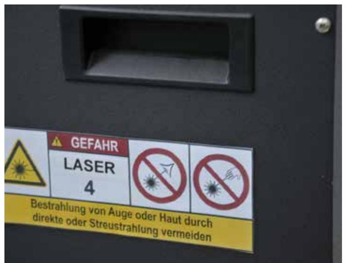
Abb. 41: Kennzeichnung der Laserklasse 4, Quelle: BG ETEM
