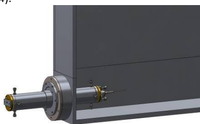
Abb. 2: Einbausituation am Lasermodul mit gekoppelter Schnittstelle
