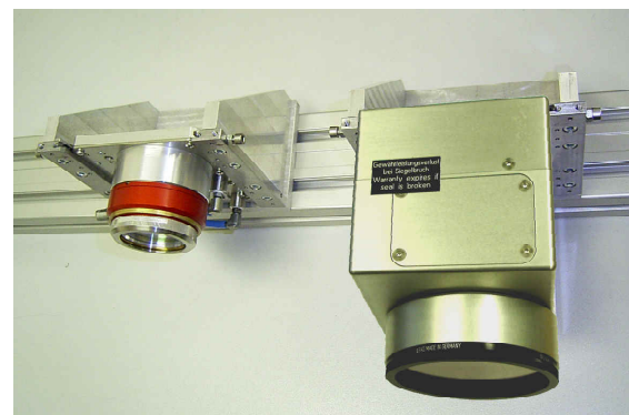
Abb. 4 Automatisch einwechselbare Laserwerkzeuge in der Ablageposition, links: Laserhärte- und Beschriftungswerkzeug, rechts: Laserbeschriftungswerkzeug
