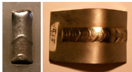
Abb. 3 Schweißergebnis und Biegeprobe
